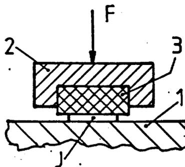
**DISPOSITIF DE MESURE DE FORCE AU MOYEN DE JAUGES
